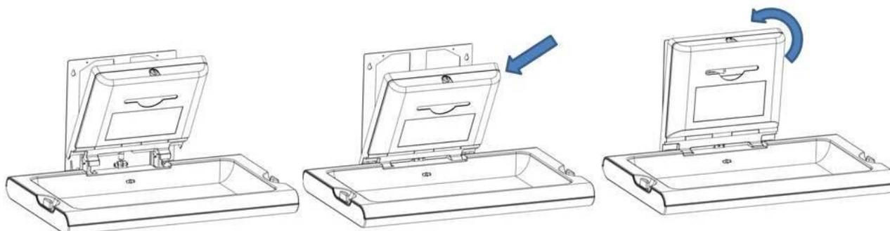
Coloque o dispensador de frente para a estrutura de fixação do trocador de fraldas e alinhe os orifícios de montagem do dispensador.
