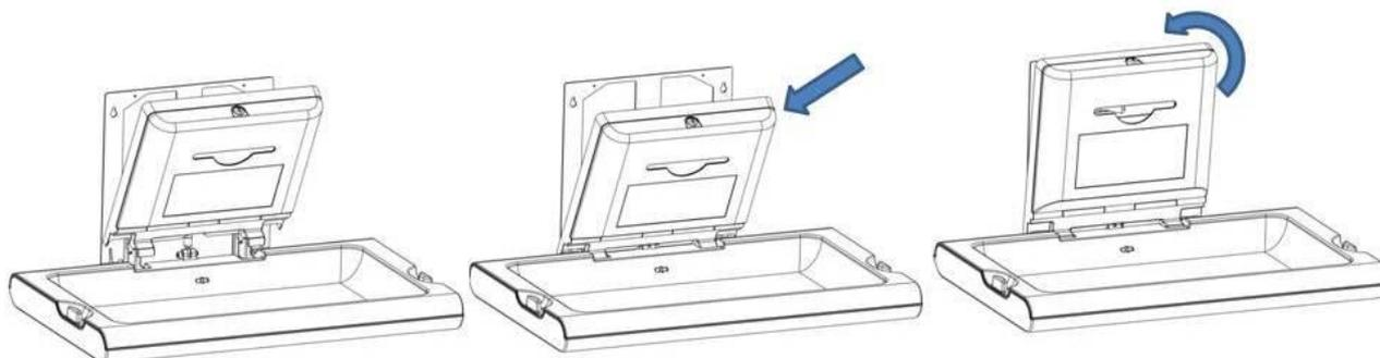
Sovrapporre il dispenser alla struttura di sostegno del fasciatoio e allineare i relativi fori di montaggio.
