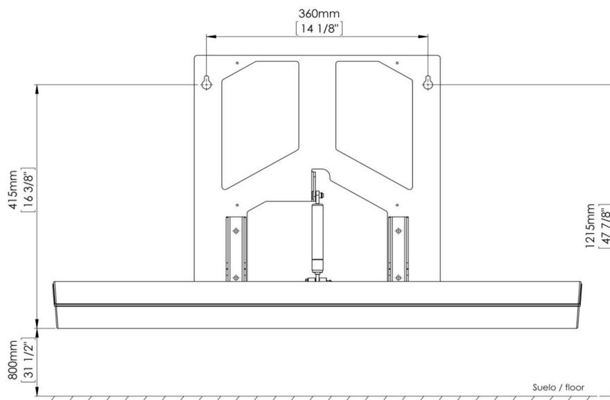
Nach der gleichen Vorgehensweise markieren Sie an der Wand mit dem Bleistift die zwei Stellen, an denen die oberen Löcher für die Halterung gebohrt werden sollen. Achten Sie vor dem Bohren darauf, dass die Positionen für die Löcher auf gleicher Höhe sind.
