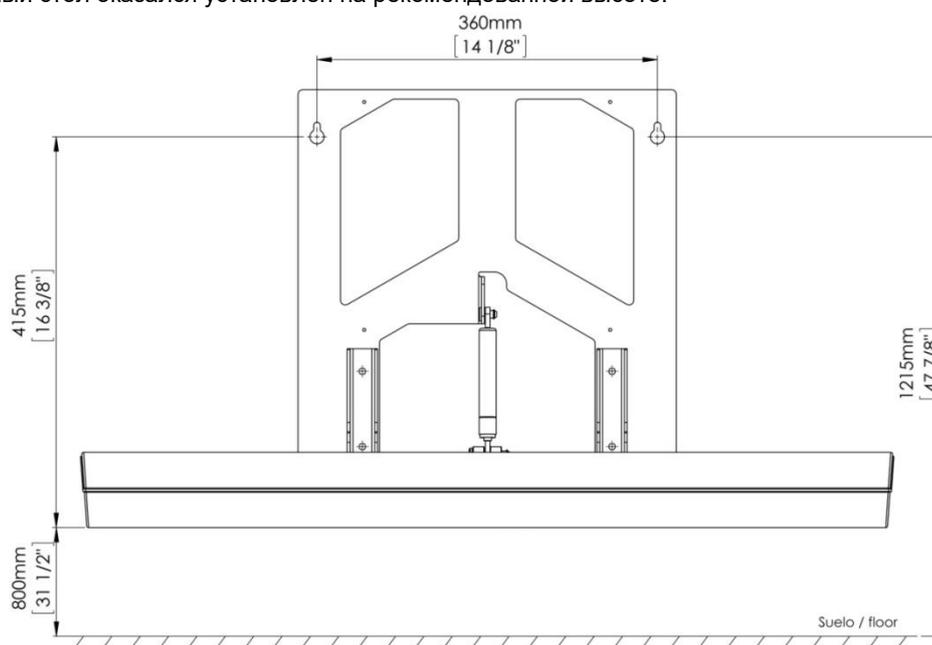
Следуя предыдущему рисунку, поставьте карандашом на стене пометки для двух верхних отверстий для крепежной структуры пеленального стола. До начала сверления отверстий очень важно убедиться в том, что поставленные карандашом пометки находятся на одном уровне.
