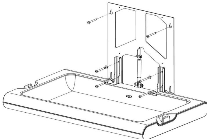
Comprobar que los seis tornillos de fijación de la unidad a la pared han sido correctamente apretados y que el cambia pañales se encuentra firmemente fijado a la pared.
