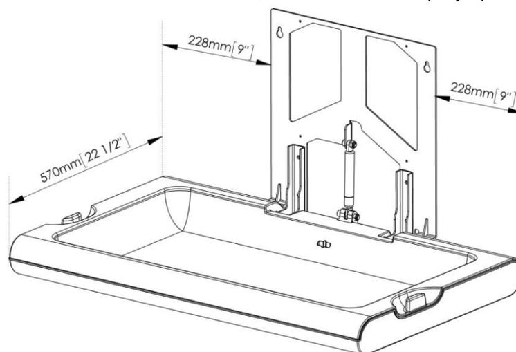
Рекомендованная высота установки — 800 мм от пола до самой нижней части пеленального стола. Следующий рисунок показывает, на какой высоте должны быть сделаны отверстия, чтобы пеленальный стол оказался установлен на рекомендованной высоте:
