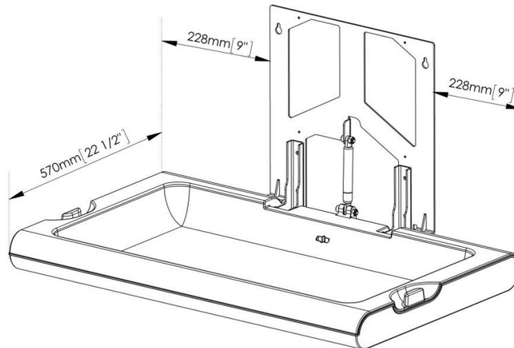
La altura recomendada de instalación es de 800 mm desde el suelo hasta la parte más baja del cambia pañales. El croquis siguiente muestra a qué altura deben realizarse los agujeros para que el cambia pañales quede instalado a la altura recomendada:
