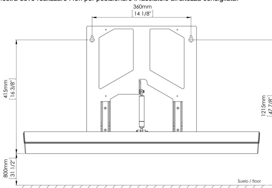
In base al disegno precedente tracciare a matita, sulla parete, i punti in cui realizzare i due fori superiori della struttura di fissaggio del fasciatoio. Prima di trapanare, è fondamentale verificare che i punti dei fori di montaggio tracciati a matita si trovino alla stessa altezza.
