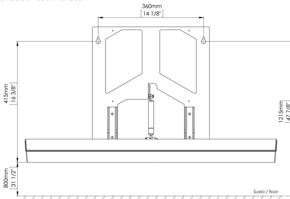
En suivant le schéma antérieur, marquer à l'aide d'un crayon sur le mur les deux trous supérieurs de la structure de fixation de la table à langer. Il est important de s'assurer que les emplacements marqués au crayon pour les trous de montage soient au même niveau avant de percer.
