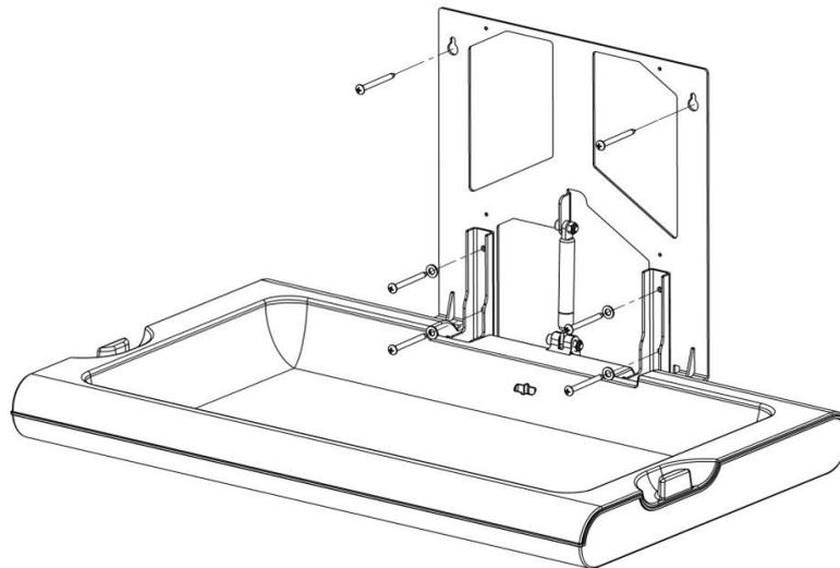
Stellen Sie sicher, dass alle sechs Befestigungsschrauben für die Wandhalterung richtig angezogen sind und der Wickeltisch fest an der Wand angebracht ist.
