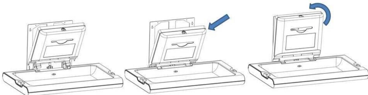
Совместите диспенсер с системой крепления стола и выровняйте монтажные отверстия диспенсера.
