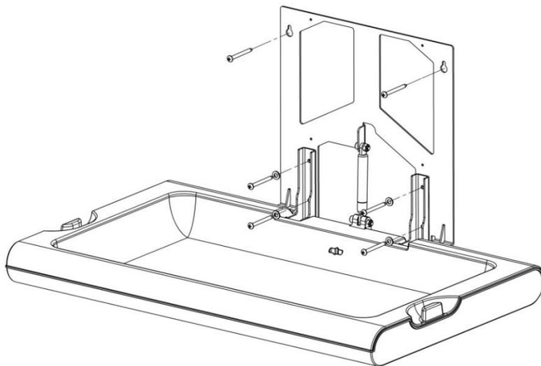
Проверьте, что все шесть винтов крепления устройства к стене должным образом закручены и пеленальный стол надежно держится на стене.
