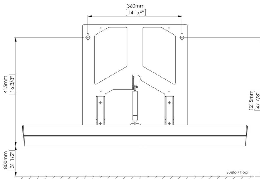
Siguiendo el esquema anterior marcar con el lápiz, sobre la pared, los dos agujeros superiores de la estructura de sujeción del cambia pañales. Es muy importante asegurar que las ubicaciones que se hayan marcado a lápiz para los agujeros de montaje estén al mismo nivel antes de realizar las perforaciones.
