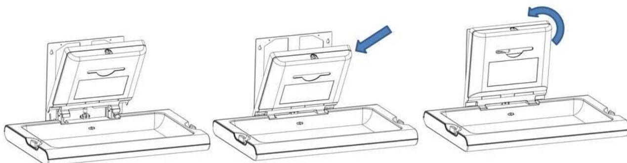
Encastrez le distributeur à la structure de fixation de la table à langer et aligner les orifices de montage au distributeur.
