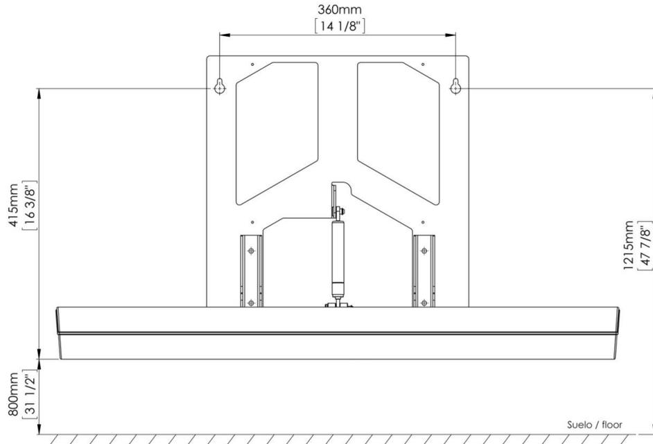
بناء على الرسم السابق، قم باستخدام القلم الرصاص لتحديد أماكن ثقب الجزء العلوي لهيكل تثبيت سرير تغيير الحفاضات على الحائط. من المهم جدًا التأكد من أن الأماكن التي قد تم تحديدها بالقلم الرصاص لتقريب التركيب تقع على المستوى نفسه قبل عمل الثقوب.
