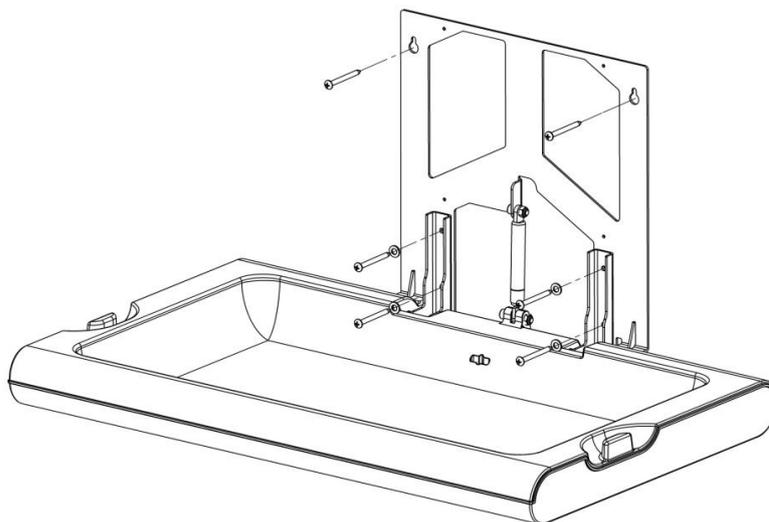
Vérifier que les six vis de fixation de l'unité au mur ont été correctement serrées et que la table à langer est fermement fixée au mur.
