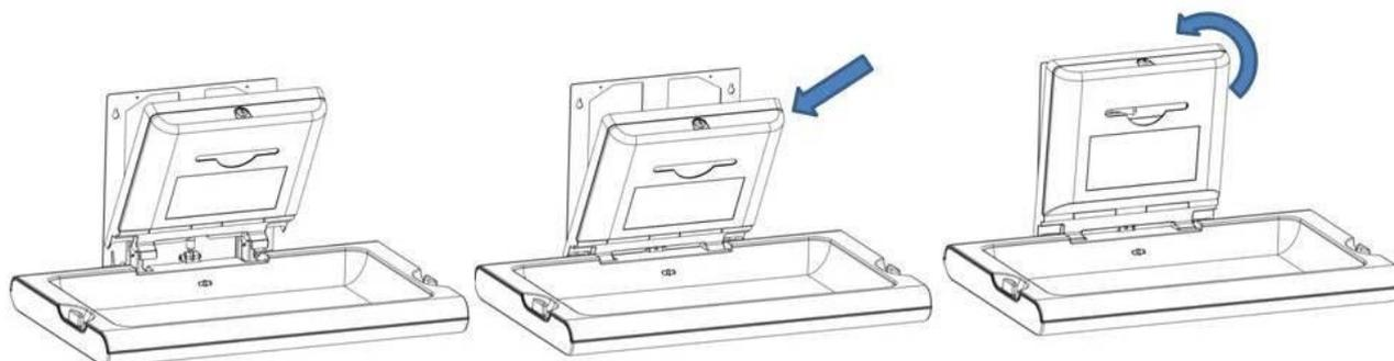
Abrir el dispensador de sabanitas con la llave especial suministrada. Los cuatro orificios de fijación de este dispensador de sabanitas a la estructura de sujeción del cambia pañales quedarán a la vista.
