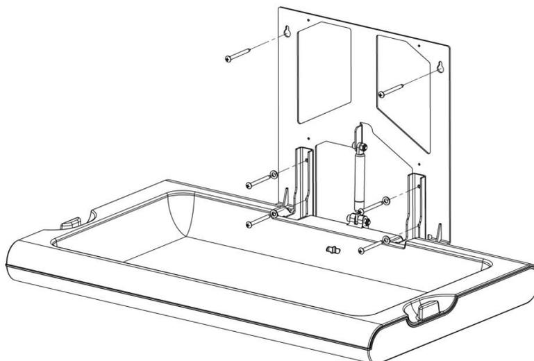
Verificare che le sei viti di fissaggio a parete dell'unità siano state avvitate in modo corretto e che il fasciatoio sia assicurato saldamente al muro.
