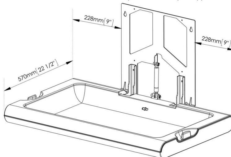
La hauteur recommandée d'installation est à 800 mm du sol jusqu'à la partie la plus basse de la table à langer. Le croquis suivant montre à quelle hauteur les trous doivent être percés pour que la table soit installée à la hauteur recommandée :
