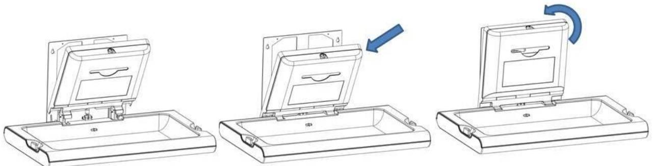
Positionieren Sie den Spender auf der Halterung und richten Sie die Befestigungslöcher aus.
