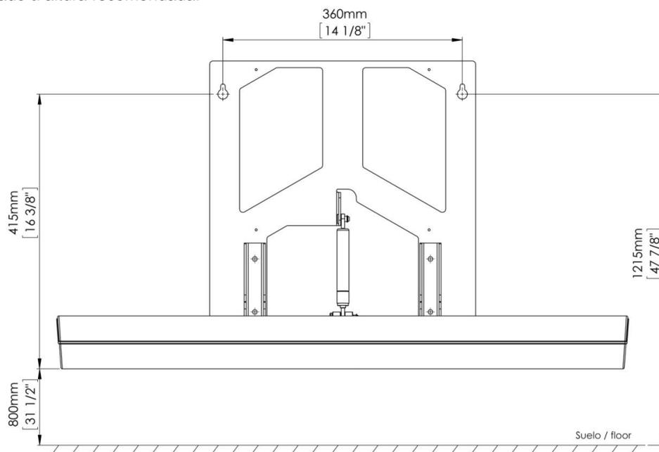
Seguindo o esquema anterior marque em cima da parede os furos superiores da estrutura de fixação do trocador de fraldas com o lápis. É muito importante assegurar que as localizações marcadas com o lápis para os furos de montagem estão no mesmo nível que antes de realizar as perfurações.
