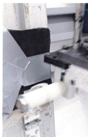
Bild 5 Cyklisk provning av krok. Strax innan kroken släpper lasten
