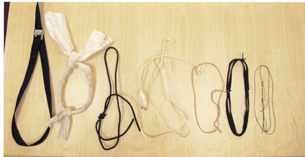
Bild 2 Utrustning använd vid belastning av krok. Från vänster: spännrem, lakansväv, elkabel 5 mm, elkabel 5,6 x 3,2, snöre 2 mm, skosnöre och snöre 1 mm.
